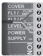
Détecteur de débit FL1 ② et ⑤
