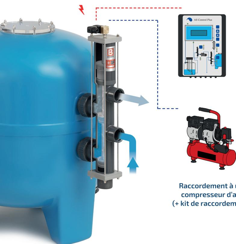
La vanne Besgo 5 voies fonctionne de manière automatique et est actionnée par air. Un petit compresseur d'air apportera les 3,5 bars nécessaires.
