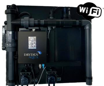
Le DA-GEN® complet Redox inclue les options suivantes : Module wifi, contrôle désinfection redox, détecteur débit, module température, canne d'injection pH minus, lecteur TDS, mesure et contrôle du pH (incl. pompe doseuse Stenner), pompe de floculation automatique Stenner (AUX1). Pré-monté et entièrement raccordé sur panneau 75x75cm.
