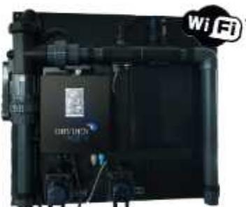
Le DA-GEN® complet Redox inclue les options suivantes : Module wifi, contrôle désinfection redox, détecteur débit, module température, canne d'injection pH minus, lecteur TDS, mesure et contrôle du pH (incl. pompe doseuse Stenner), pompe de floculation automatique Stenner (AUX1). Pré-monté et entièrement raccordé sur panneau 75x75cm.
