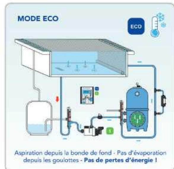
Lorsque le mode Eco est activé, l'aspiration se fait directement depuis la piscine afin que l'eau ne déborde pas. L'évaporation et les pertes d'énergie sont ainsi considérablement réduites. En même temps, la vitesse de filtration est automatiquement réduite au niveau le plus bas. Avec un investissement d'environ 4000 EUR vous pouvez économiser au minimum 10'000 kWh par saison.
