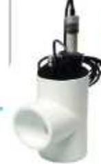
← Sonde pH/Redox unique ne nécessitant pas de calibration (s'auto-corrige grâce à l'I.A)
