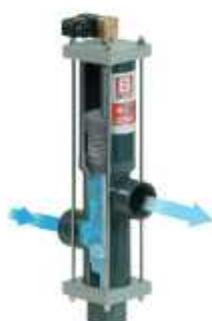
Avec l'installation d'une vanne 3 voies Besgo et d'un AS Control Plus, l'eau peut être aspirée en fonction de la température extérieure soit par les goulottes de débordement, soit par la bonde de fond.
